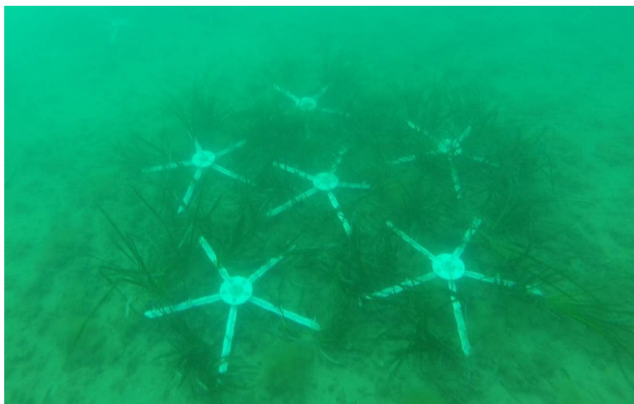
Figura 18: Disposizione di 6 moduli di ancoraggio che emulano una patch di Posidonia (giugno 2016).
